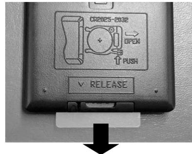
リモコンを使用する前に透明な絶縁フィルムを引き抜いてください。
